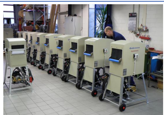
Afgewerkte assemblage van slangwasmachines SW
