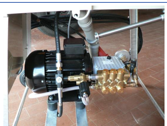
Hoge druk eenheid voor 140 bar
